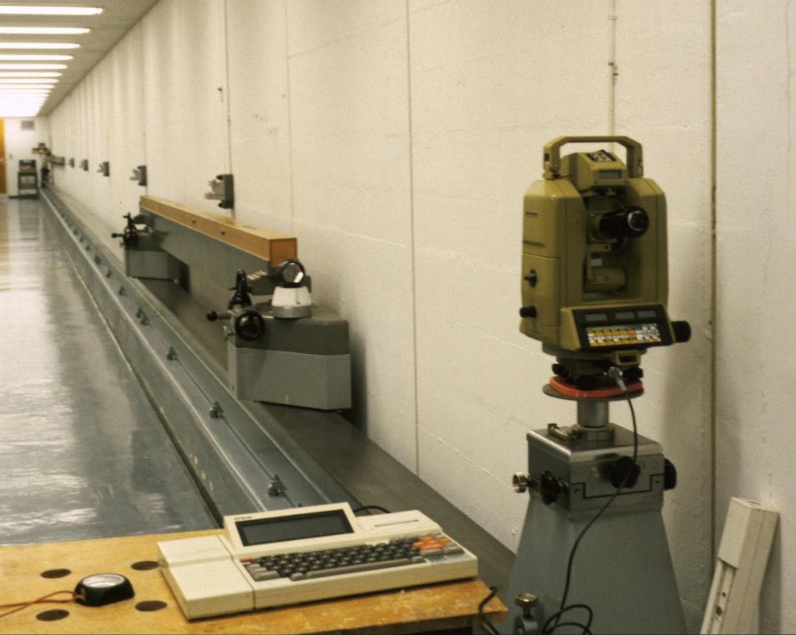
Leica-Wild T2000 Distomat DI2000 laboris kaugusmõõtja kalibreerimine
